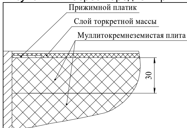
Рисунок 11. Разрез передней крышки
